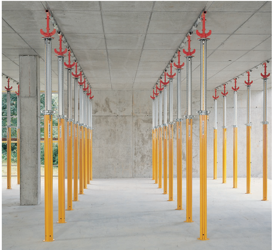
MULTIPROP 350 und SKYDECK Deckenschalung im ausgeschalteten Zustand. Nur 0,29 Stützen/m 2 Deckenfläche bis 40 cm Deckenstärke.
